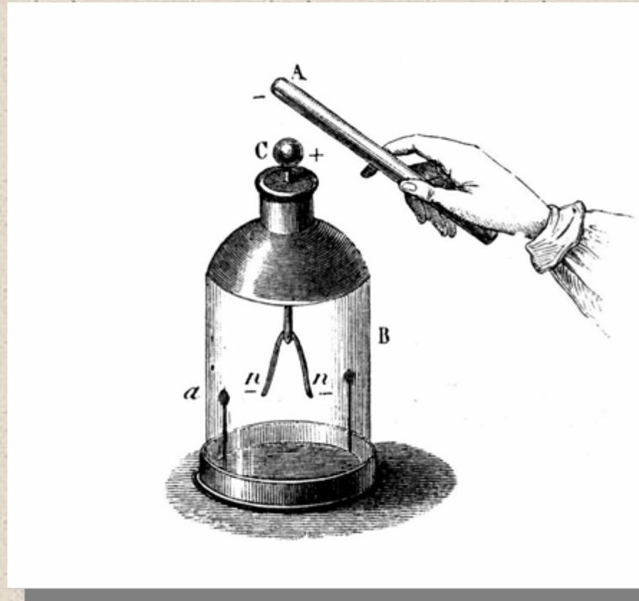
Un électroscope semblable à celui que Becquerel a utilisé pour montrer que les substances radioactives avaient la propriété de rendre l'air conducteur de l'électricité.
