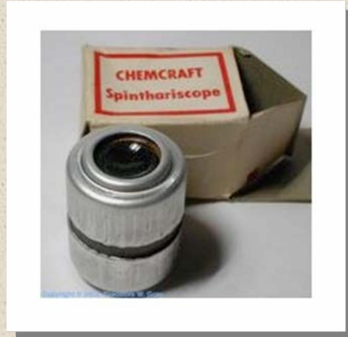
Le spintharoscope de William Crookes qui permettait de voir les scintillations provoquées par la traversée d'un écran de sulfure de zinc par des particules  $\alpha$ .
