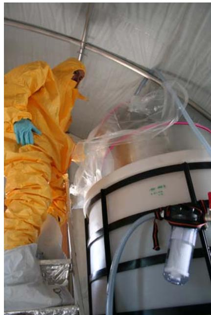
**Figure 16 : Fondoir utilisé lors de la troisième expédition de collecte de micrométéorites à CONCORDIA (Janvier 2006)**
