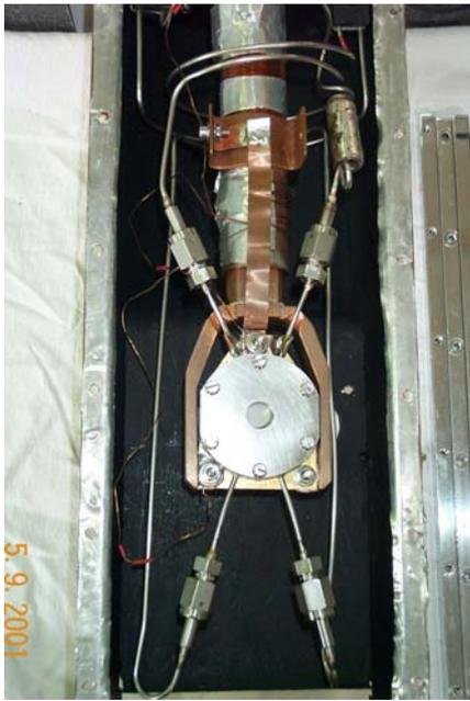
Figure 4.3 : Cible cryogénique pour  $H_2/D_2$  solide
