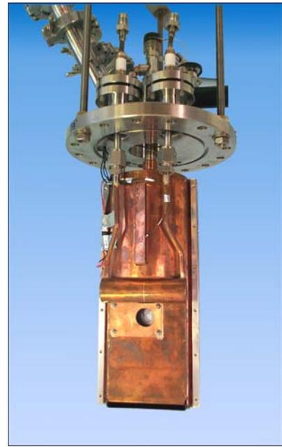
Figure 4.4 : Cible cryogénique pour  $H_2/D_2$  solide
