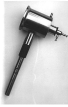
FIG. 7 — Le compteur à pointe de Geiger, 1913. À droite, le schéma de montage, avec un électromètre à fil.
