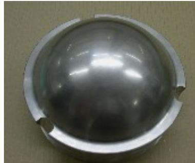
**Figure 9 :** Fenêtre en T91 de la cible du projet MEGAPIE [27].
