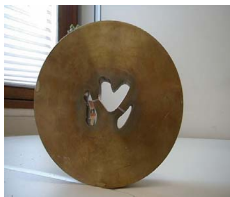
Fig. 11 : collimateurs finaux: collimateur multi-lames photons (fig de gauche) et collimateur personnalisé en laiton pour les protons (figure de droite)
