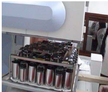
Figure 6 : Arrangement des tubes photomultiplicateurs à la sortie du cristal scintillant.
