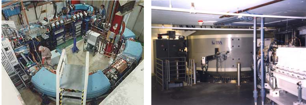
Fig. 9 : Synchrotron (anneau) et cyclotron à protons de 230 MeV
