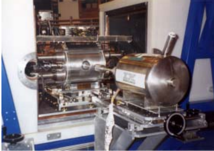
FIG. III.12 – Vue du spectromètre TAGS installé à ISOLDE (au premier plan on observe le télescope germanium pour l'observation des particules X et gamma).
