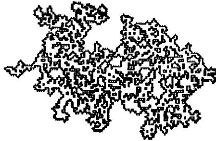
Fig.3-3 : Exemple d'amas obtenu dans le modèle des épidémies sur réseau carré à p=0.5927 . (D'après la réf.13.)
