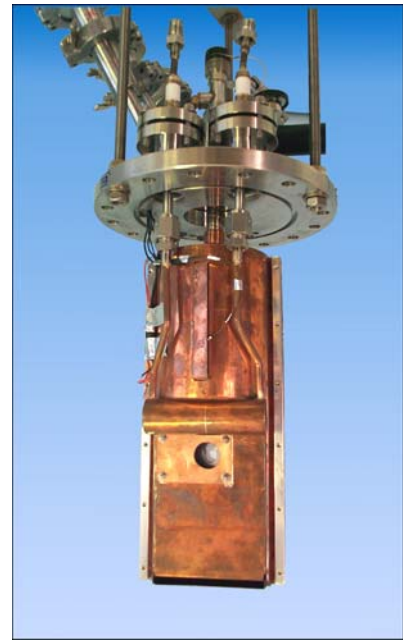
Figure 4.2 : Cible cryogénique pour H_2/D_2 solide
