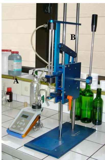
Figure 1 : Matériel de dosage de l'oxygène dissous dans les vins en bouteille. (a) électrode à oxygène, (b) système de perçage échantillonnage.
