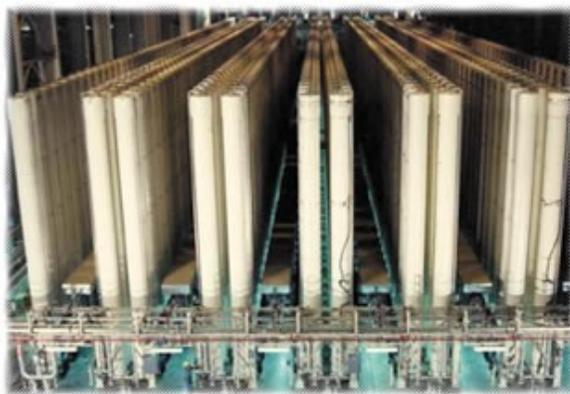
Le gaz d'uranium est introduit dans des cascades de milliers de centrifugeuses comprenant un rotor de 1 à 2 m de haut et de 15 à 20 cm de diamètre. Pour une séparation efficace, les centrifugeuses doivent tourner à 50 000-70 000 tours par minute.
