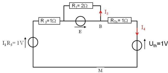
La résistance  $R_1$  est soumise à la tension  $E = R_1 I_3$  ce qui donne un courant  $I_3 = E/R_1 = 0,5A$
