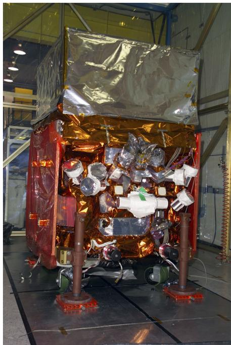
**Figure III.1** - Image de l'observatoire *Fermi* durant les tests de qualification au NRL (*Naval Research Laboratory*). Le LAT est le détecteur recouvert de la couverture anti-météorites argentée et se trouvant au dessus de la plateforme. Le GBM est composé des plus petits détecteurs en avant plan. Crédits : NRL
