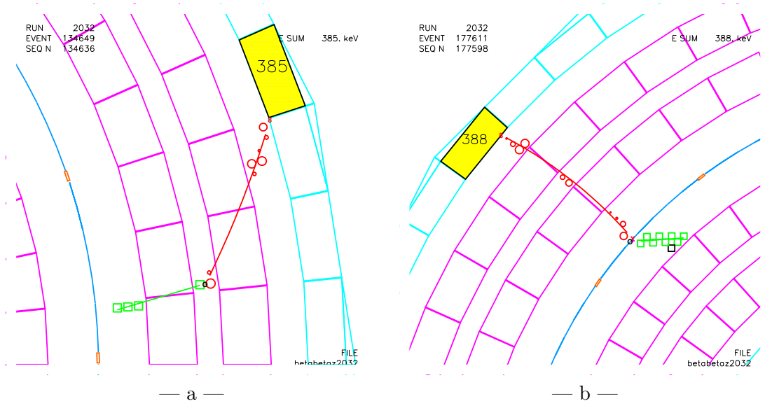
FIGURE 2.9 – Décroissance BiPo observée par NEMO 3 sur un fil d’une cellule Geiger (a) et sur/dans une des feuilles source de ^{100}\text{Mo} (b). La trace de l’électron est indiquée par les cercles rouges et celle de la particule \alpha retardée avec les carrés verts.
