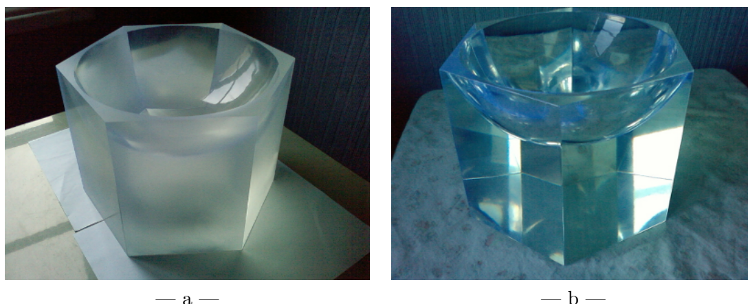
FIGURE 5.27 – Photos du scintillateur hexagonal en polystyrène utilisé pour l'étude du polissage dans son état initial (a) et au stade entièrement poli (b).
