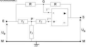
$$\text{Au nœud Q} : \frac{V_E - V_Q}{R} + \frac{V_S - V_Q}{R} + i^- = 0 \quad donc \ V_E - V_S = 2V_Q = 2V_P = 2\frac{r_3}{r_1 + r_3}U_e = 2\frac{r_3}{r_1 + r_3}V_E$$
