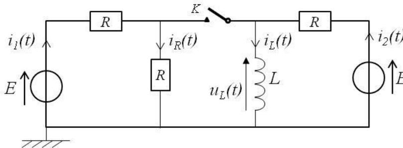
Remplir le tableau ci-dessous en justifiant les réponses, pour cela on aura besoin d'écrire les différentes équations de Kirchhoff impliquant les variables  $i_1(t)$ ,  $i_2(t)$ ,  $i_L(t)$ ,  $i_R(t)$ ,  $u_L(t)$  et les éléments du circuit  $E$ ,  $L$  et  $R$ .
