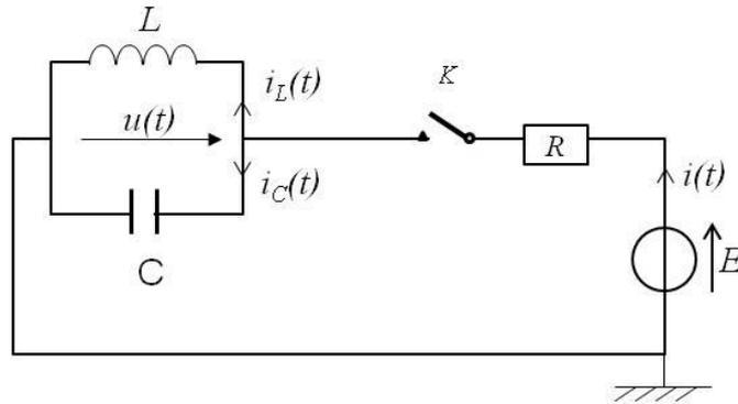
A  $t = 0$  on ferme l'interrupteur  $K$ , le condensateur  $C$  étant initialement déchargé.
