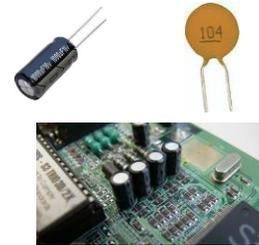
Un condensateur est caractérisé par sa **capacité C**, mesurée en Farad (F)
