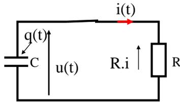
à l'instant  $t=0$  le condensateur est chargé  $u(0) \neq 0$ , il porte la charge  $q(0) = C \cdot u(0) = C u_0$ ; on ferme l'interrupteur  $k$  et le courant commence à passer.
