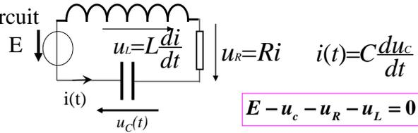
mise en équation (SSM)  $u_c + LC \frac{d^2 u_c}{dt^2} + RC \frac{du_c}{dt} = 0$
