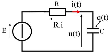
à l'instant  $t=0$  le condensateur est déchargé  $u(0)=0$ , et  $q(0)=0$ . on ferme l'interrupteur  $k$  et le courant commence à passer.
