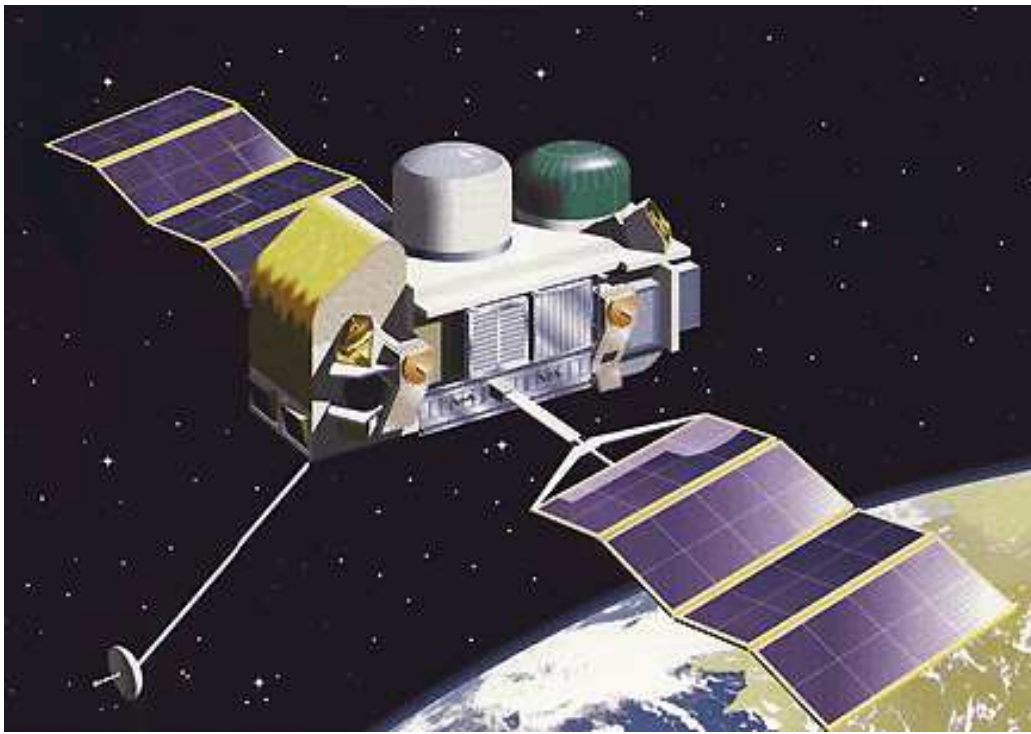
FIG. 1.1: Satellite de la mission CGRO (Compton Gamma Ray Observatory). Ce fut la seconde grande mission de la NASA. Lancé le 5 avril 1991, les quatre détecteurs à bord permirent une couverture du spectre électromagnétique sur six décades en énergie (30 keV - 30 GeV). Dans l'ordre croissant de leur domaine d'énergie : Burst And Transient Source Experiment (BATSE), Oriented Scintillation Spectrometer Experiment (OSSE), Imaging Compton Telescope (COMPTEL), et Energetic Gamma Ray Experiment Telescope (EGRET).
