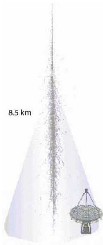
FIG. 1.13 – Schéma de principe d'un imageur Cerenkov
