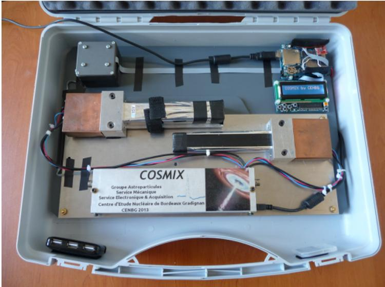
La platine supportant le détecteur a été élargie afin de pouvoir recevoir les nouveaux composants permettant de mettre en œuvre le comptage d'événements.
