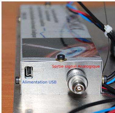
Les deux sorties analogiques de COSMIX doivent être connectées à l'aide d'un câble BNC-banane aux entrées analogiques EA0 et de la centrale d'acquisition.
