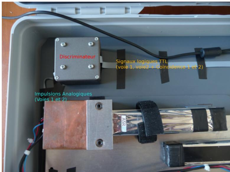
Le comptage se fait à partir de signaux logiques produits par deux discriminateurs (un par voie) dont leur seuil a été réglé à 100mV, c'est à dire que chaque discriminateur génère un signal logique (TTL, tension carrée à +5V) à partir du moment où le signal analogique franchit le seuil de 100mV.
