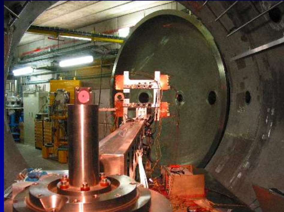
Détecteur en place dans la cuve à vide
